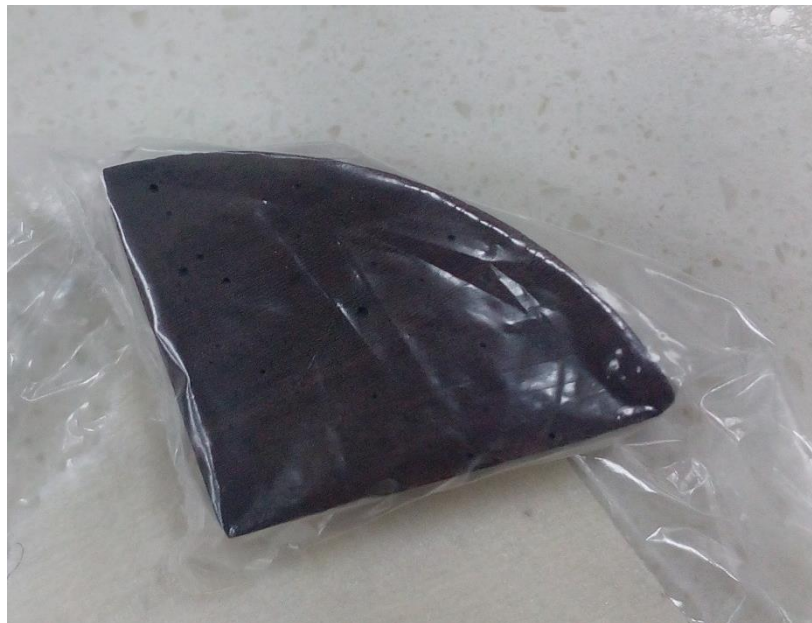
Figura 76 Sección de pastilla recubierta con oro para su análisis en SEM.
