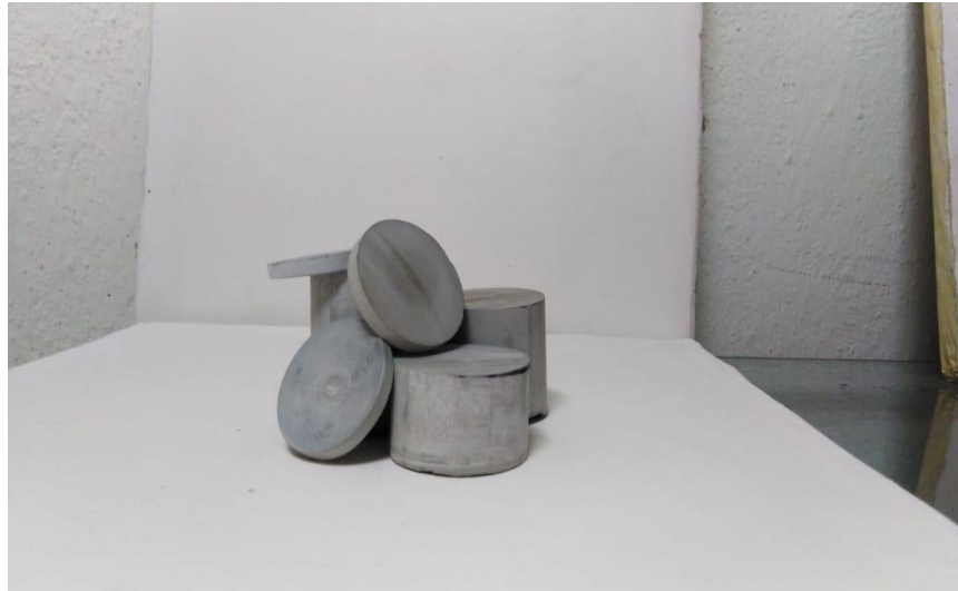
Figura 76 Sección de pastilla recubierta con oro para su análisis en SEM.
