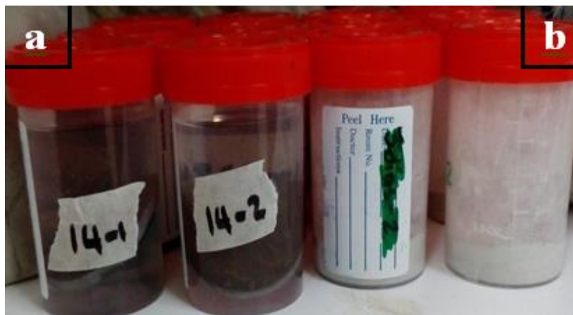
Figura 74 Almacenaje de muestras. a) Pastilla de cemento a 14 días de hidratación sumergida en isopropanol para detener la reacción. b) Polvo de cemento a 7 días de hidratación preparado para ser analizado por XRD y TGA.
