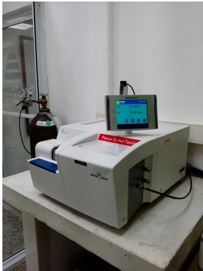
Figura 72 Equipo para TGA utilizado en la investigación.
