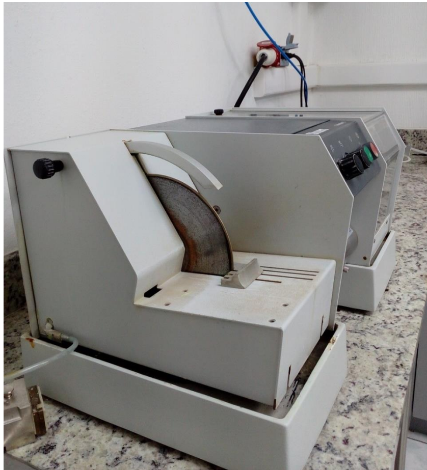
Figura 78 Cortadora de diamante usada para hacer las pastillas de cemento.
