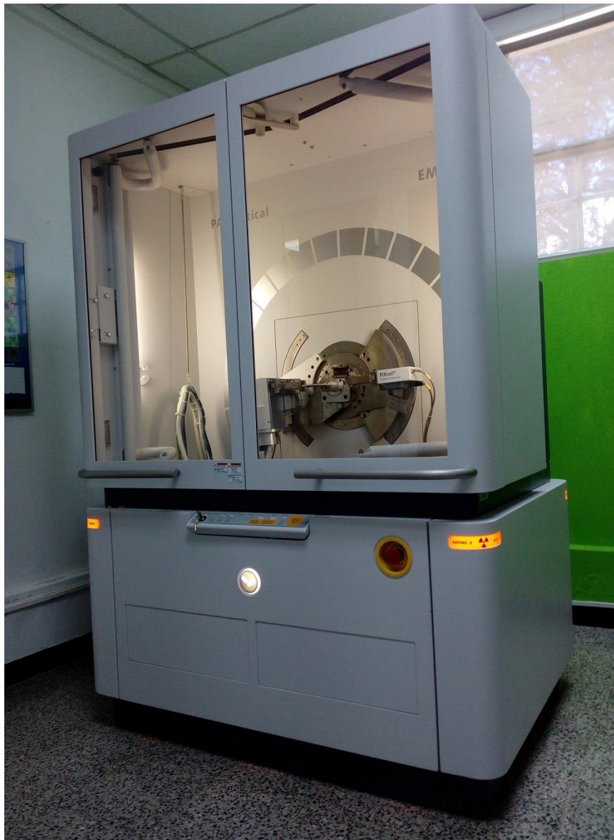
Figura 70 Equipo de Difracción de Rayos X utilizado en la investigación.
