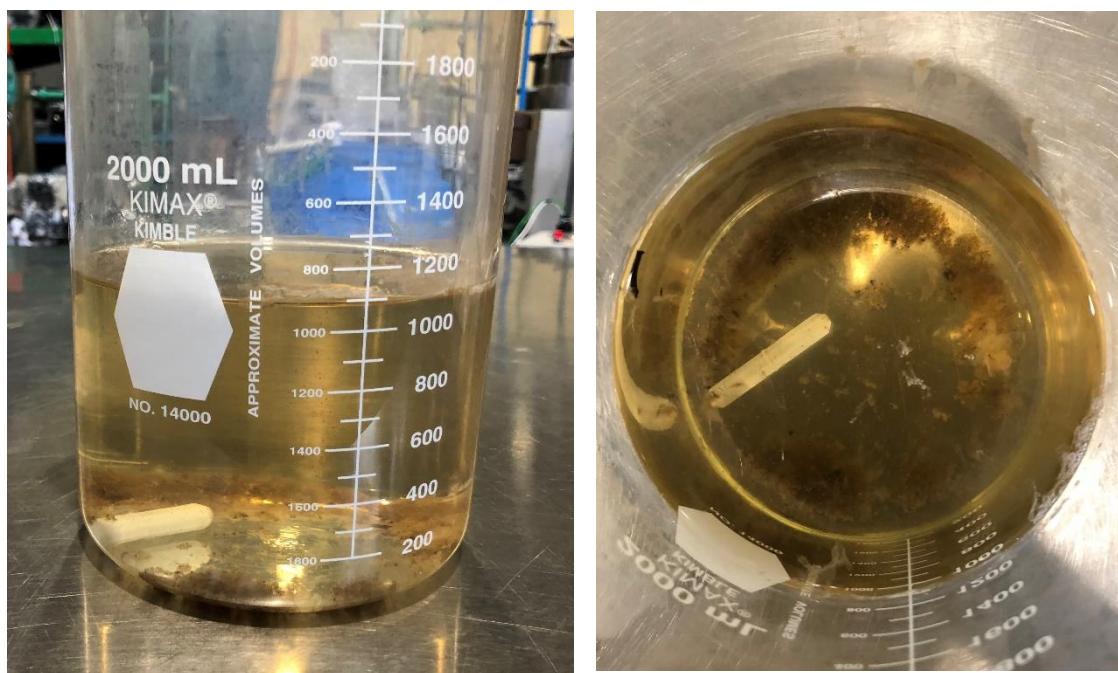
Figura 142 Agua al finalizar el tratamiento, con los sólidos sedimentados
