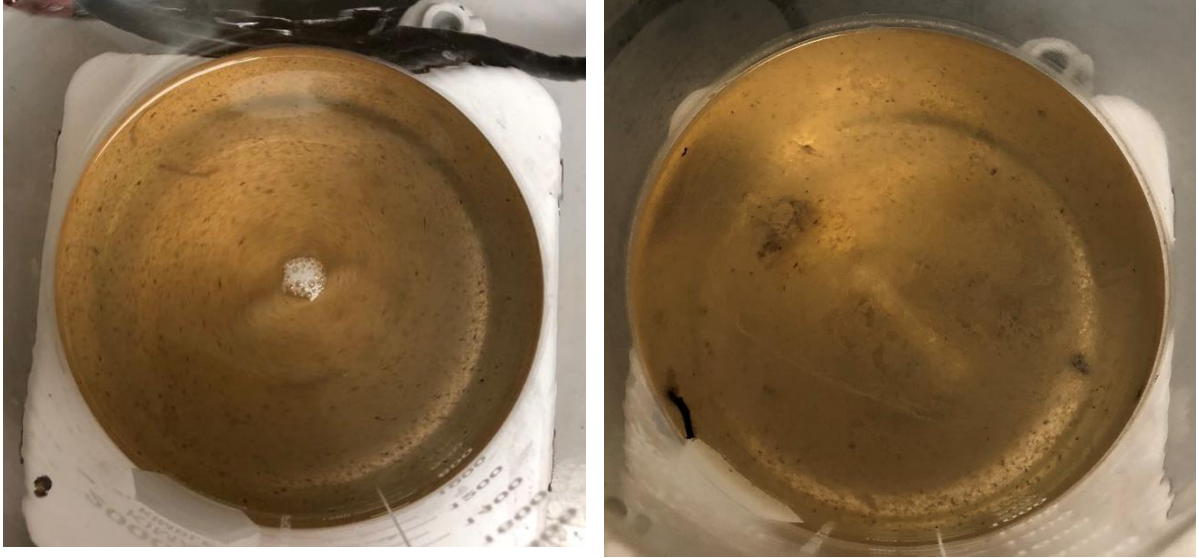
Figura 139 Espuma formada y crecimiento de algas en el agua residual tratada durante la segunda prueba
