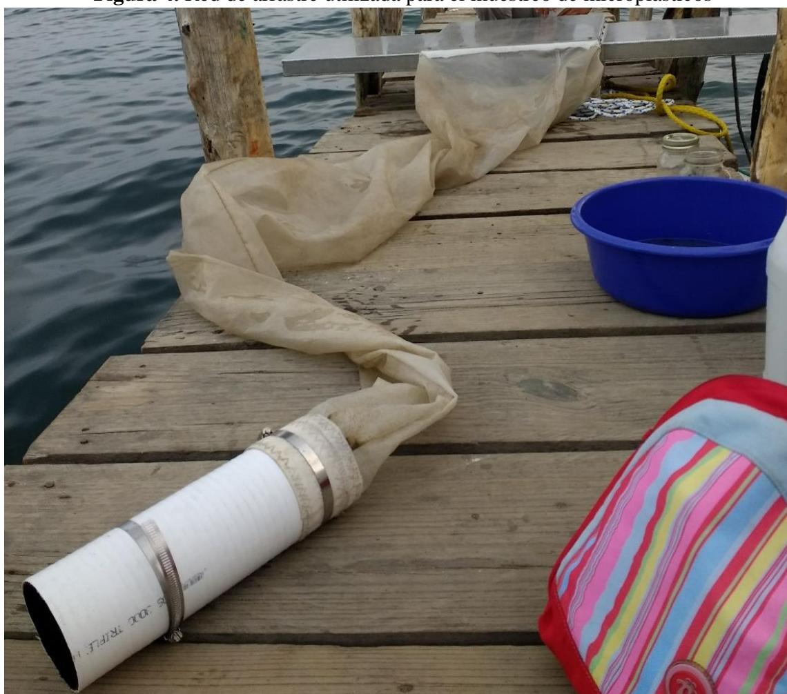
Figura 4. Red de arrastre utilizada para el muestreo de microplásticos
