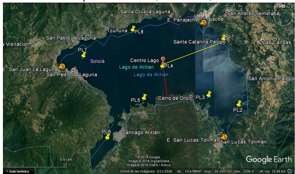
Figura 7. Ejemplo de la medición del ángulo entre la dirección del viento (línea roja) y el punto de muestreo (línea amarilla).
