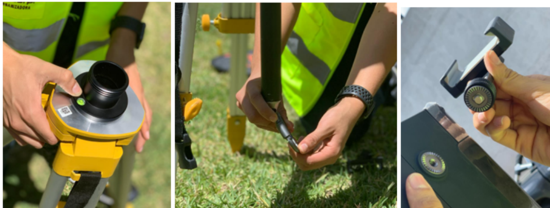
Figura 17: “Colocación de contrapeso y soporte para el móvil en antena”
