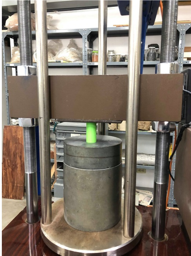
Figura 37: Máquina de ensayos universales configurada para ensayo de compresión.
