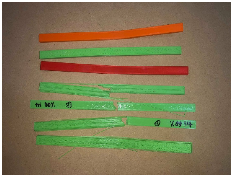
Figura 71: Probetas de flexión ensayadas Se puede observar una muestra de las probetas luego de ser sometidas al ensayo de flexión.
