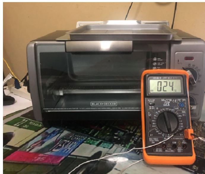
Figura 41: Horno de convección y multímetro para prueba térmica.
