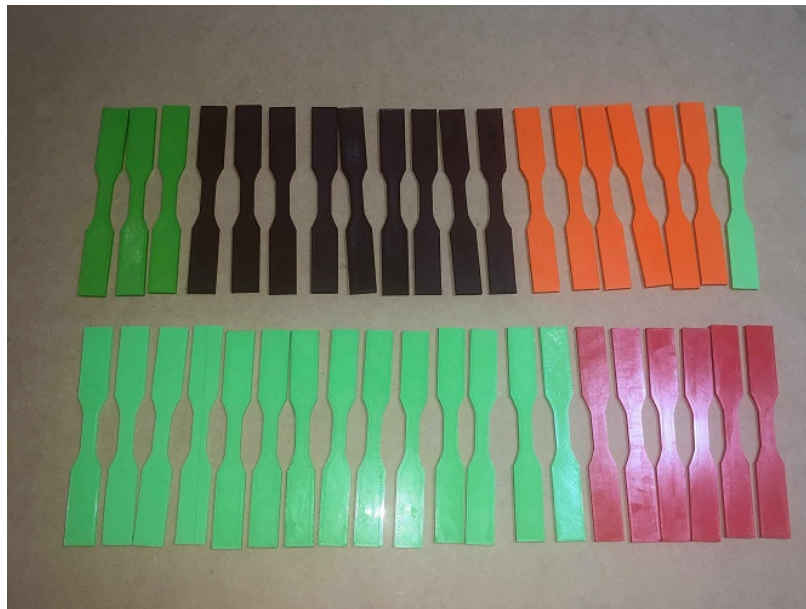
Figura 64: Probetas de tracción Se puede observar una muestra de las probetas para el ensayo de tracción.
