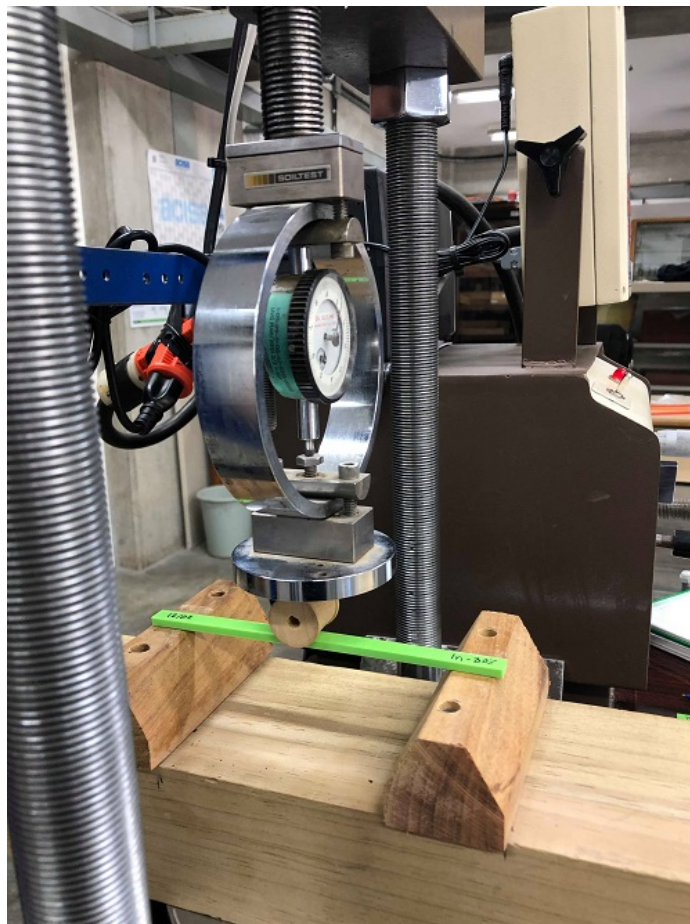
Figura 40: Máquina de ensayos universales configurada para ensayo de flexión.
