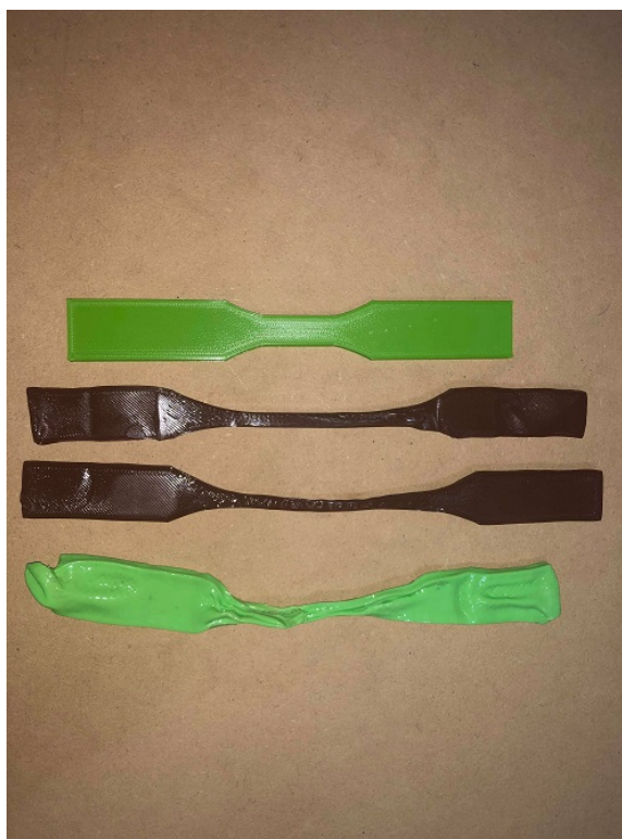
Figura 72: Probetas de prueba térmica Se puede observar una muestra de las probetas luego de ser sometidas a la prueba térmica.
