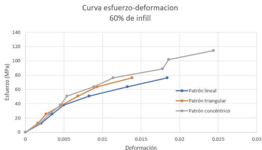
Figura 58: Ensayo de flexión: curva esfuerzo-deformación - 60 % infill Gráfica comparativa entre los tipos de patrones de rellenos utilizados con un 60 % de infill
