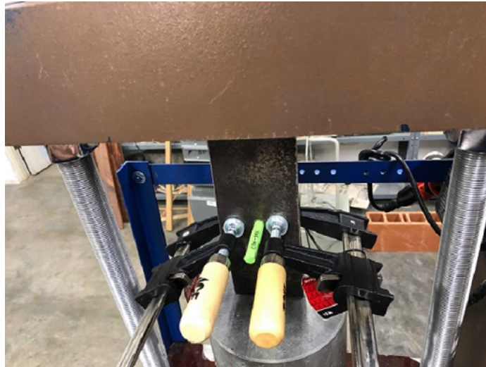
Figura 39: Máquina de ensayos universales configurada para ensayo de corte.
