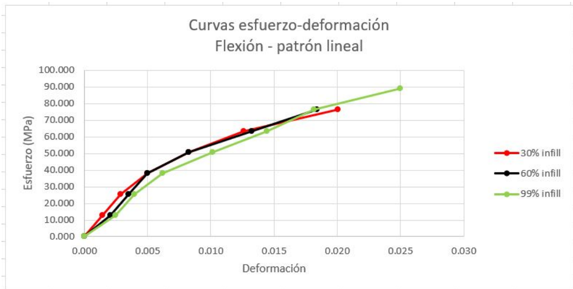
Figura 61: Ensayo de flexión: curva esfuerzo-deformación - patrón lineal Gráfica comparativa entre los porcentajes de relleno del patrón de relleno lineal.
