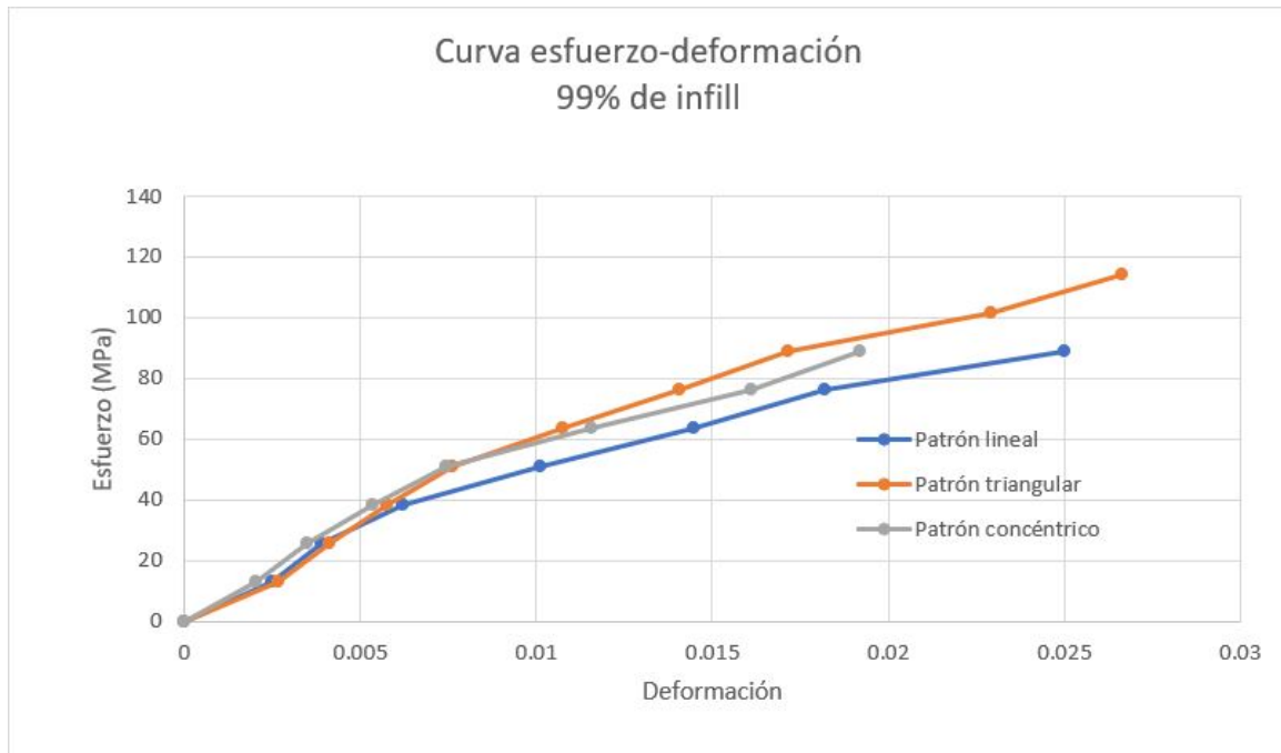
Figura 59: Ensayo de flexión: curva esfuerzo-deformación - 99 % infill Gráfica comparativa entre los tipos de patrones de rellenos utilizados con un 99 % de infill
