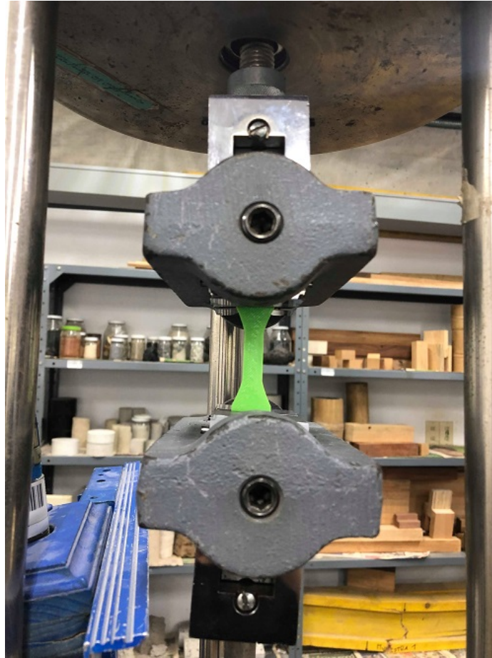
Figura 38: Máquina de ensayos universales configurada para ensayo de tracción.
