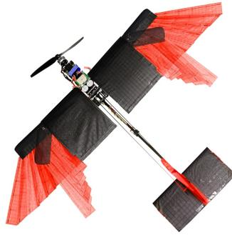
Figura 5: Dron con plumas artificiales. [5]
