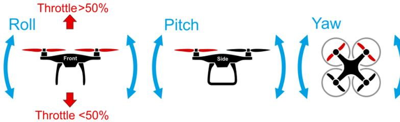
Figura 7: Ejemplificación de Roll, Pitch y Yaw. [11]
