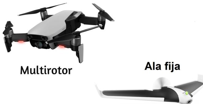
Figura 6: Comparación de drones según su forma de sustentación. [4] [8]
