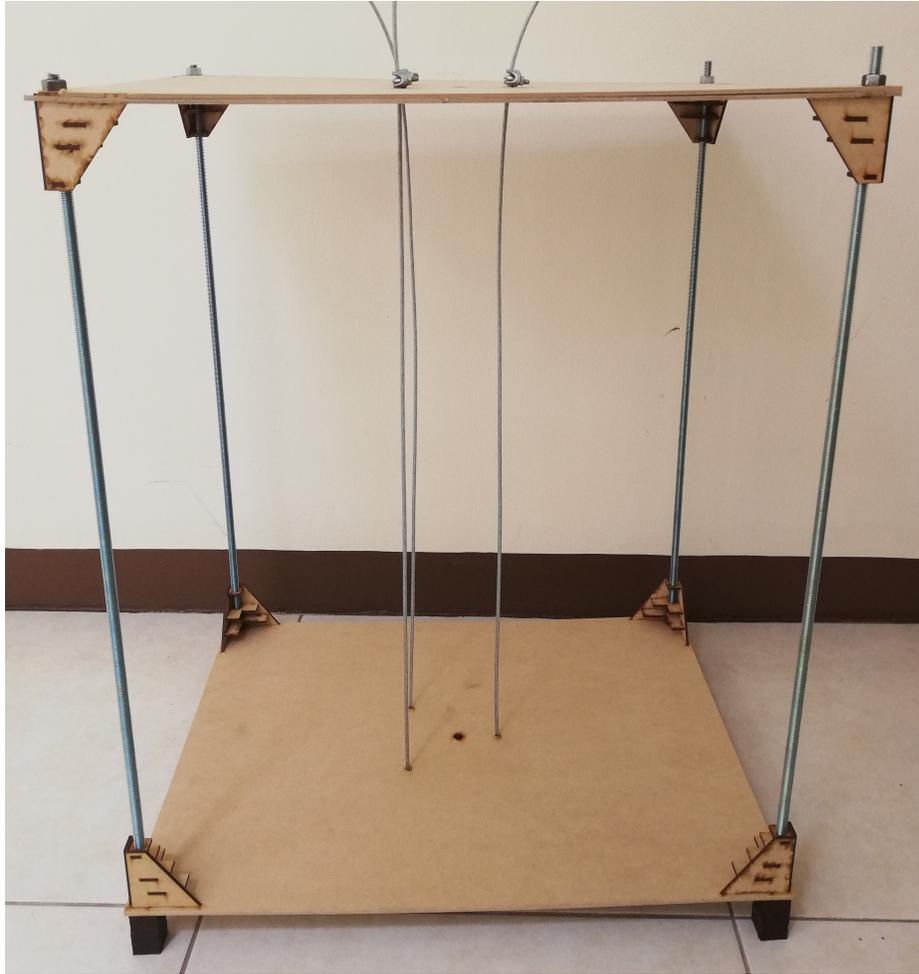
Figura 113: Unión de superficies con patas, varillas roscadas y escuadras
