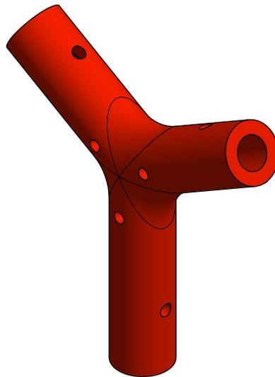
Figura 57: Diseño de unión en forma de Y de estructura de dron Modelo 5
