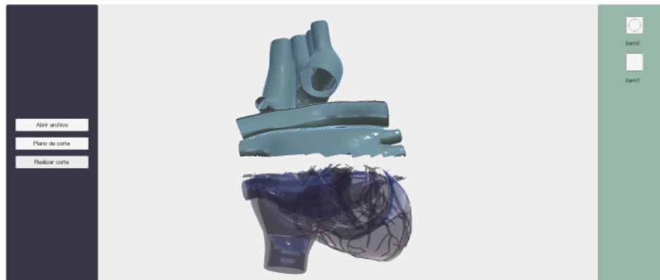
Figura 23: Resultado de un corte cuando no se toma en cuenta el caso en el que un triángulo se encuentra en ambos lados del plano.
