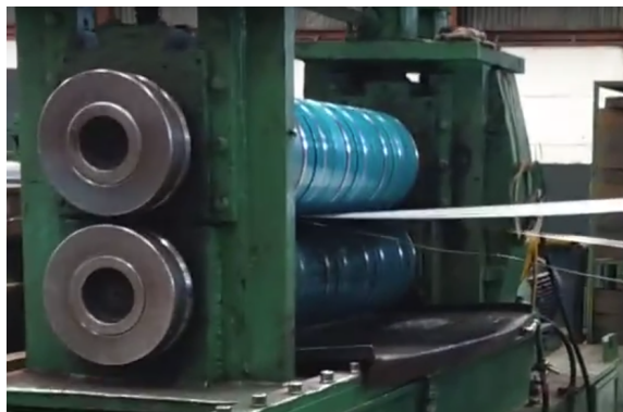
Figura 55: Acero al salir de proceso de corte.
