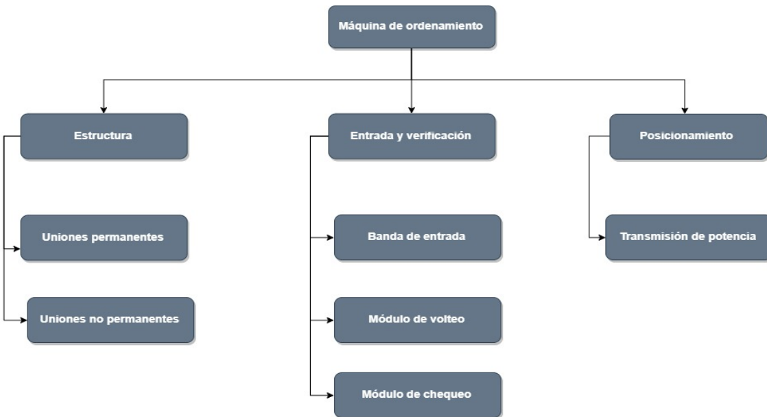
Figura 49: Distribución general de la máquina
