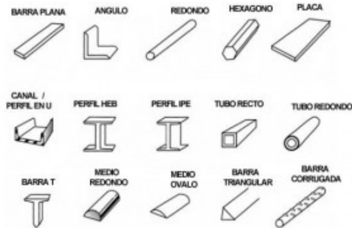
Figura 18: Perfiles estructurales comunes [5]
