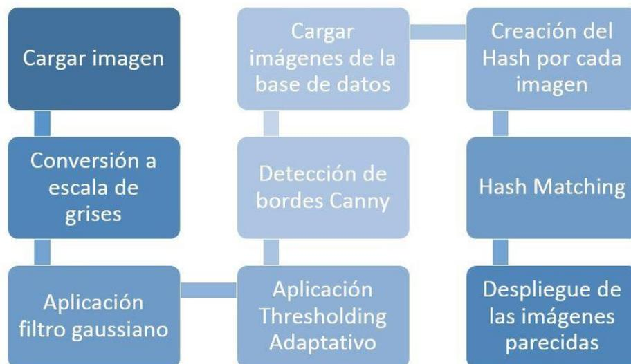
Figura 40: Etapas del reconocimiento de pistones mediante Image Hashing y detección de bordes.
