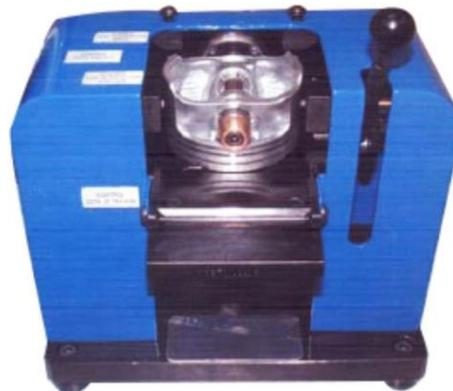
Figura 28: Dispositivo electrónico de medición y control de pistón de la empresa INFAS [2]
