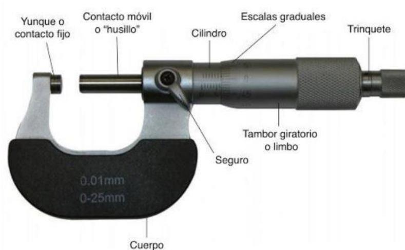
Figura 6: Partes del micrómetro de exteriores [14]
