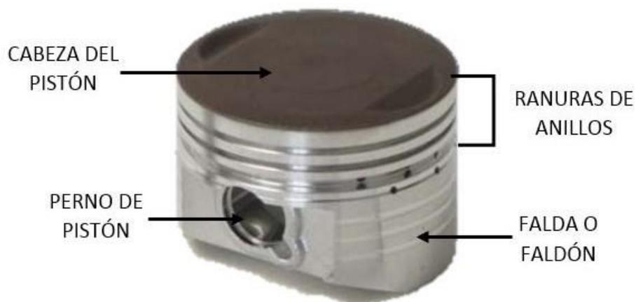
Figura 5: Partes de un pistón
