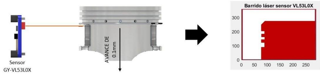
Figura 48: Escaneo 2D de la sección de las ranuras de un pistón con el sensor GY-VL53L0X.
