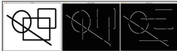
Figura 14: Aplicación filtro sobel vertical y horizontal [26]
