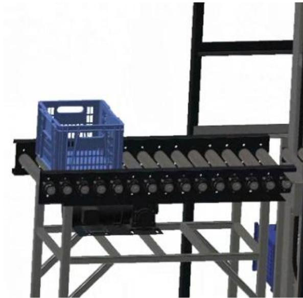
La canasta iniciará su rumbo hacia el punto de carga. Un sensor fotoeléctrico difuso detectará cuando la canasta esté justo en la orilla del transportador inferior, por lo que se detendrá.
