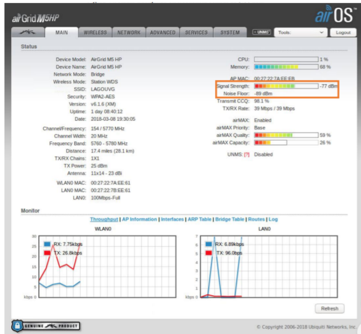
Figura 85: Radio trabajando en frecuencia central de 5.77GHz
