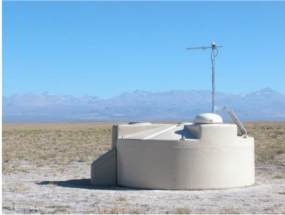
Figura 13: Detector Cherenkov en agua del Observatorio Pierre Auger [12].
