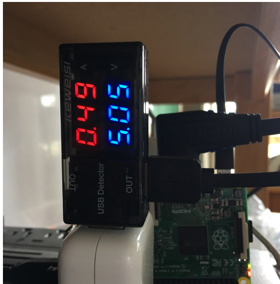
Figura 180: Medición de corriente y voltaje en Raspberry Pi 2
