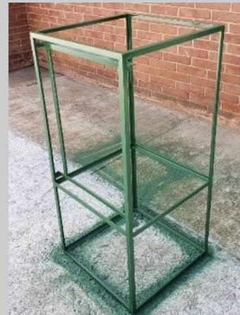
**12** Instalar la base del evaporador en la estructura interior, la lámina del cuerpo interior y las láminas correspondientes en la estructura exterior. (Se debe instalar el evaporador previamente a la lámina del cuerpo interior)
