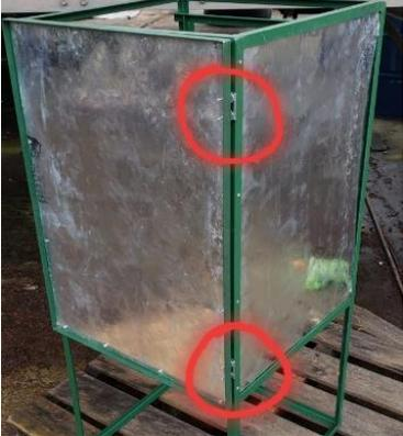
**14** Instalar el empaque magnético en el marco frontal del cuerpo interior del modelo.
