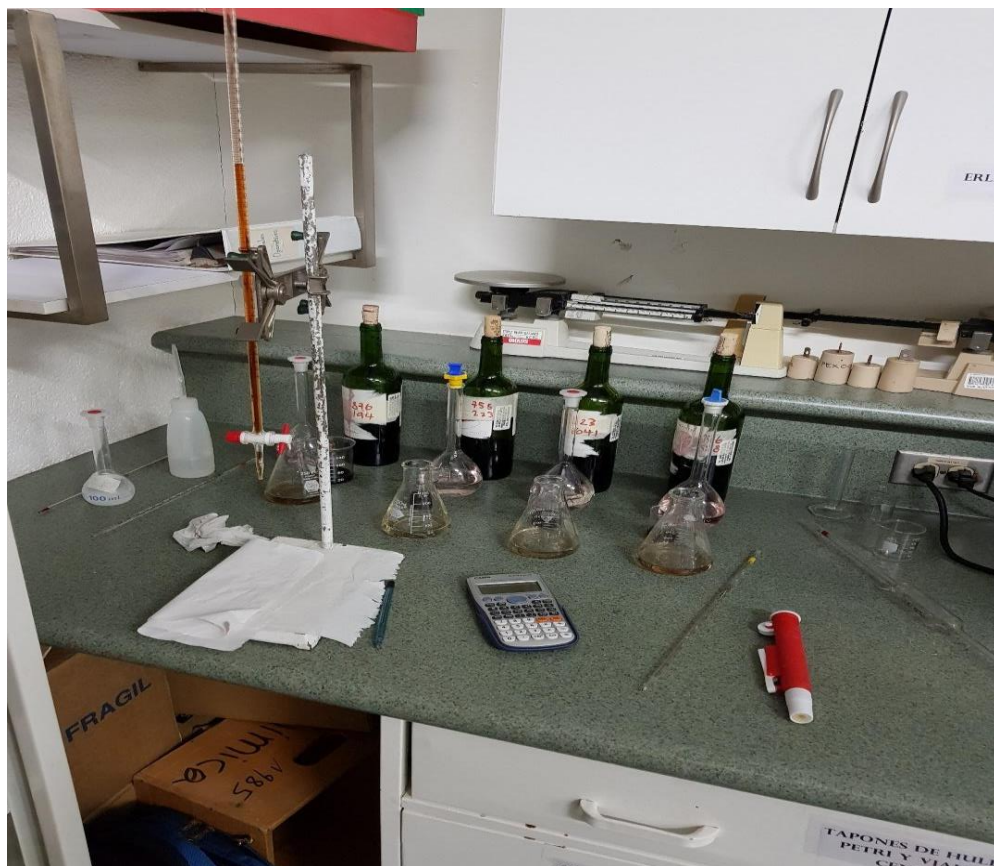
Figura 22: Realización de titulación con yodometría para \text{SO}_2
