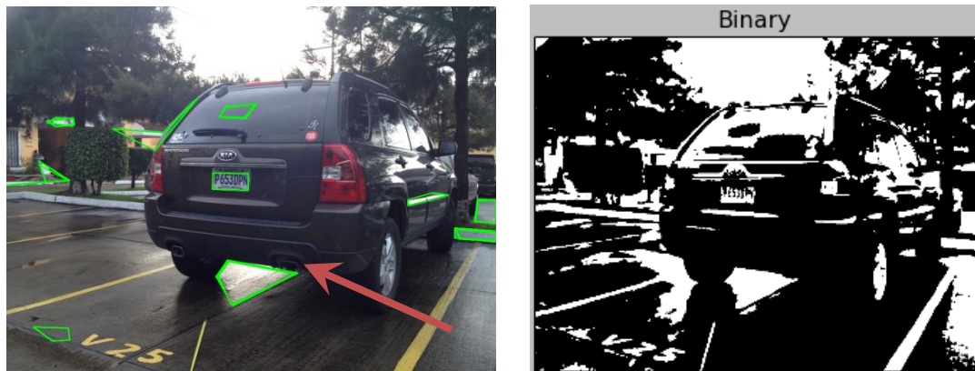
Figura 13. Reflexión en el asfalto de la imagen original (izquierda) provoca detección de contorno (derecha)
