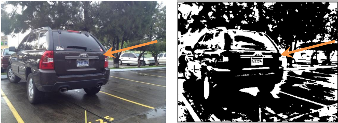
Figura 18. Foto trasera del auto, detalle cromático cerca de la placa (izquierda) puede provocar confusión en la detección de la placa (derecha)
