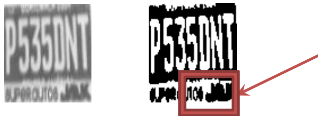
Figura 26. Ruido en la conversión binaria provocada por el diseño de marco de la placa
