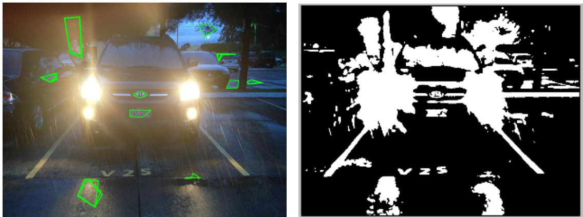
Figura 16. Foto frontal del auto, la intensidad de la luz de los faros (izquierda) provoca áreas blancas en la conversión a binario de la imagen (derecha).
