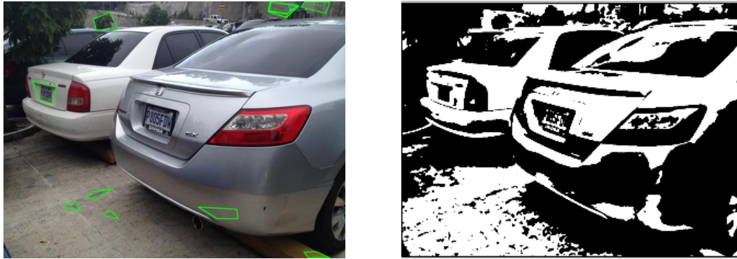
Figura 19. Foto trasera del auto, diseño de la cajuela provoca sombra interna (izquierda) y no permite visualizar correctamente toda la placa (derecha).
