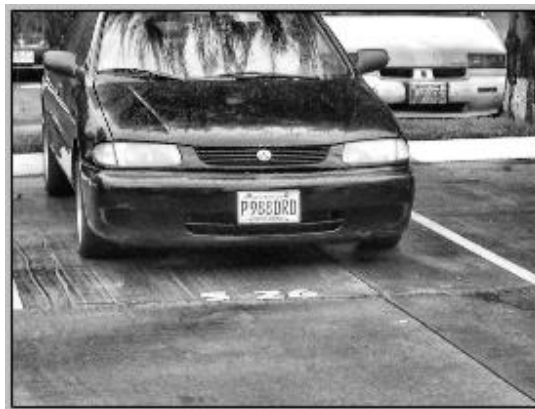
Figura 5. Imagen ecualizada por método CLAHE.
