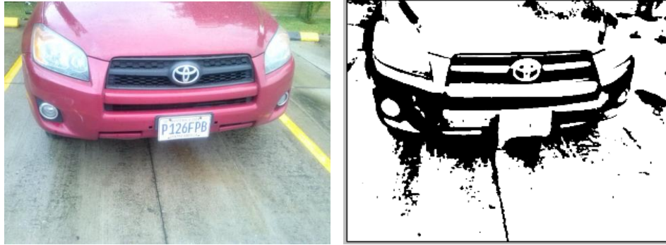
Figura 17. Foto frontal del auto, el color de la pintura del auto puede ser muy clara (izquierda) al momento de convertir en imagen binaria (derecha).
