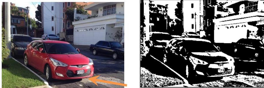
Figura 14. Foto frontal del vehículo, ángulo de rebote de luz en el bumper (izquierda) provoca que la pintura en el área sea detectada como blanca (derecha).
