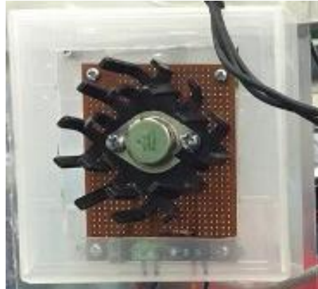
Figura 37: Módulo regulación implementado. En un encapsulado plástico, con un disipador de calor.
