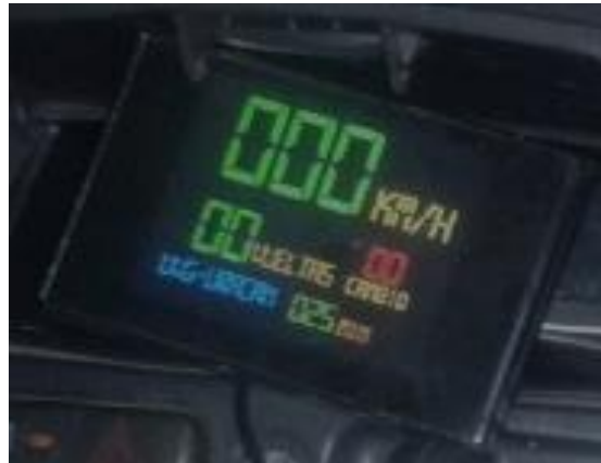
Figura 35: Implementación final de pantalla LCD. Despliegue de datos en pantalla. Se puede apreciar el módulo de competencia.
