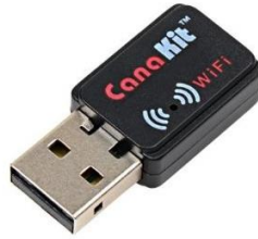
Figura 19: Módulo USB de Wi-Fi CanaKit para Raspberry Pi. Este módulo se instaló para futuras implementaciones que requieran conexión a internet o Wi-Fi.
