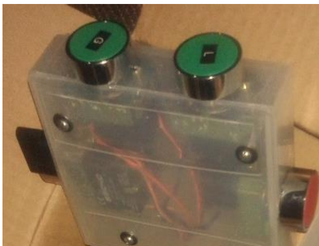
Figura 45: Sub módulo de botones. Con dos botones NO (verdes), un botón NC (Rojo) y un switch de tres posiciones NO (negro).
