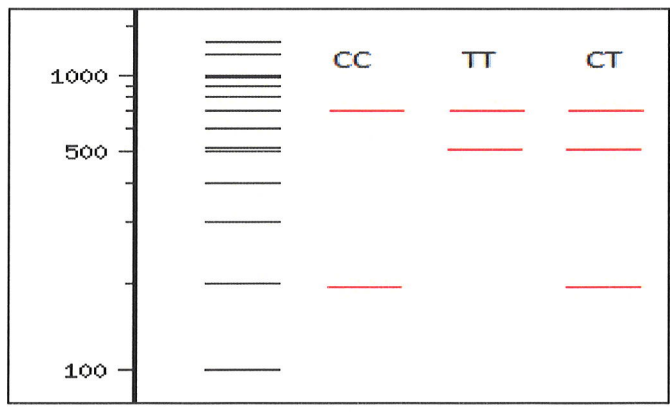
Figura 22: Resultados teóricos del PCR alelo específico con los cuatro iniciadores seleccionados de los tres alelos posibles en gel de agarosa al 2%.
