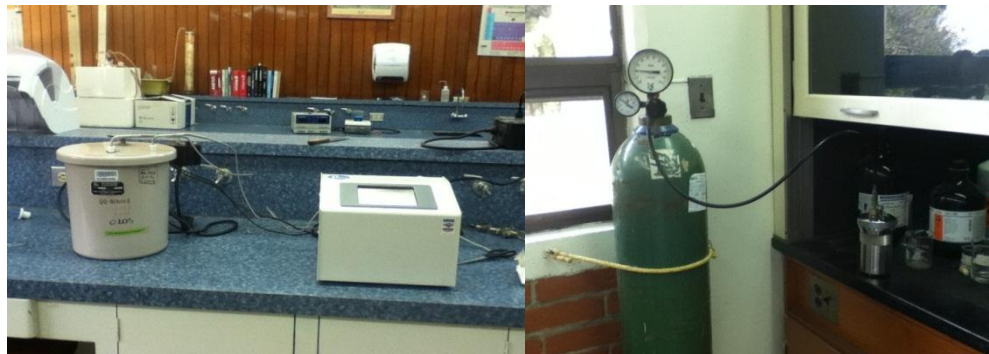
Figura No. 21: Bomba calorimétrica y termómetro PAR y sistema de presurización con oxígeno.
