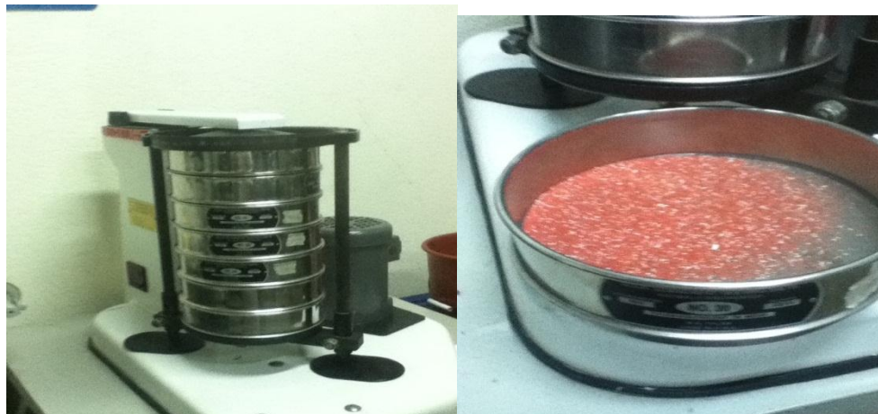
Figura No. 18: Tamizaje del polipropileno reducido para obtener las partículas del mesh 60
