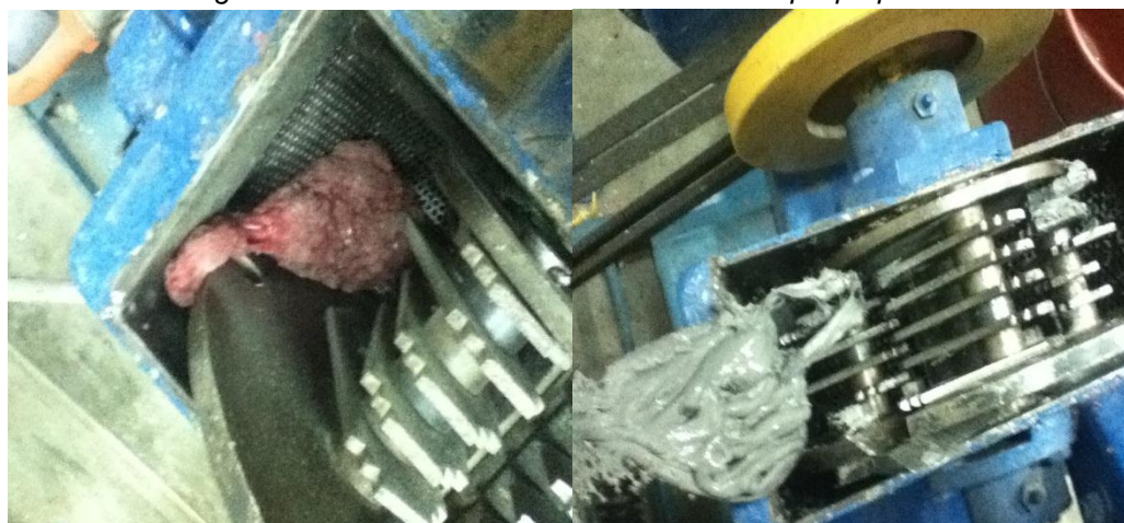
Figura No. 17: Problemas con la molienda del polipropileno
