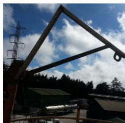
Imagen No. 33: Base para polipasto para tanque 1003A
