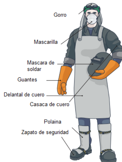
Imagen No. 28: Equipo industrial para soldar el tanque 1003A
