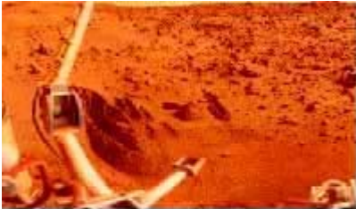
El brazo recolector de muestras del módulo de aterrizaje Viking 1 obtuvo muestras del suelo marciano y las colocó en un instrumento que las analizó en busca de señales de vida. No se encontró señal alguna.
