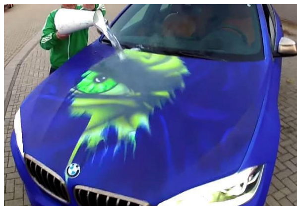
Ilustración 23. Ejemplo de uso de pintura termocromática.
