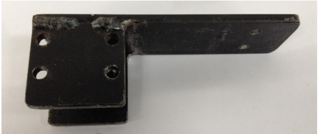
Figura 21 Pieza fabricada para sujetar motor y caja
