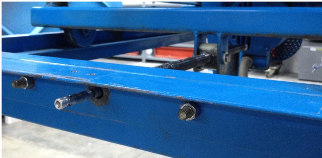
Figura 20 Parte del túnel donde se encuentra el tornillo que debe girar el motor
