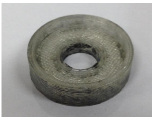
Figura 19 Pieza para centrar cojinete fabricada en impresora de plástico
