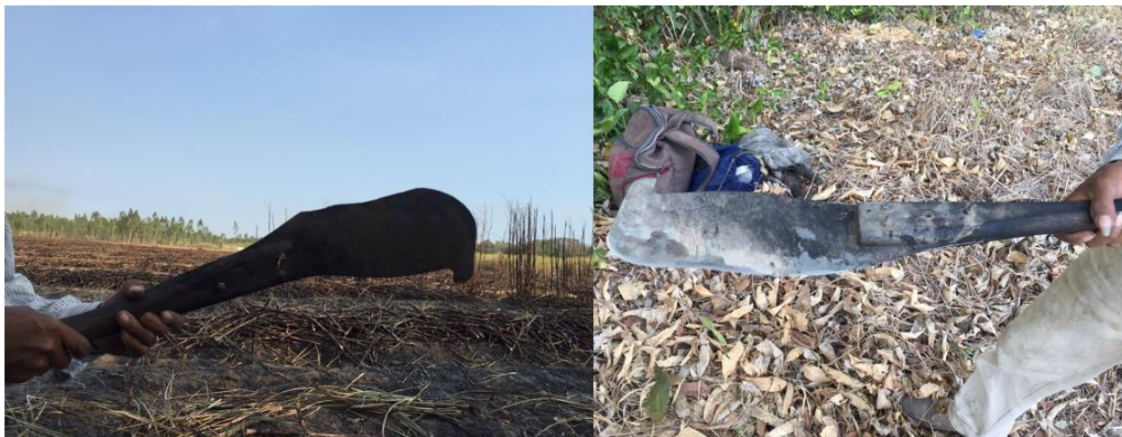
Figura 1. Vistas del machete australiano utilizado para hacer la operación de corte de caña de azúcar.
