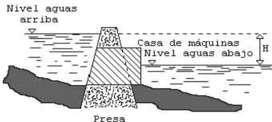
Imagen 2 Esquema de una presa
