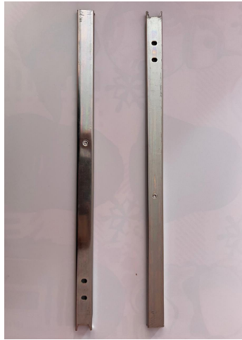
Figura 9. Barras metálicas para base del chasis.
