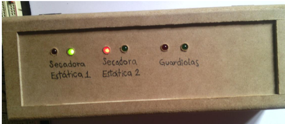
Figura 61 Prueba de laboratorio con indicadores luminosos indicando la temperatura del aire
