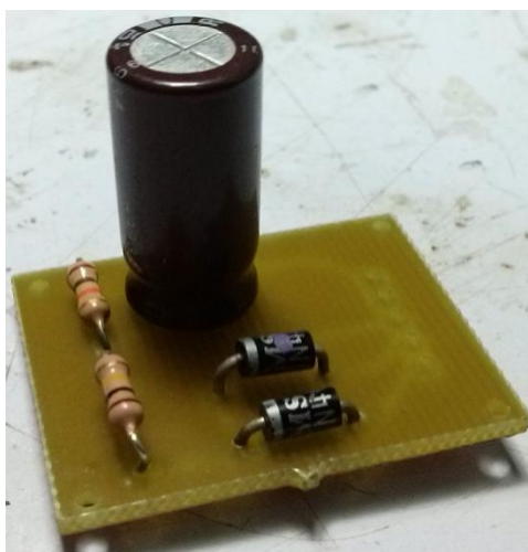
Figura 96. Circuito rectificador de voltaje AC soldado en placa de cobre.
