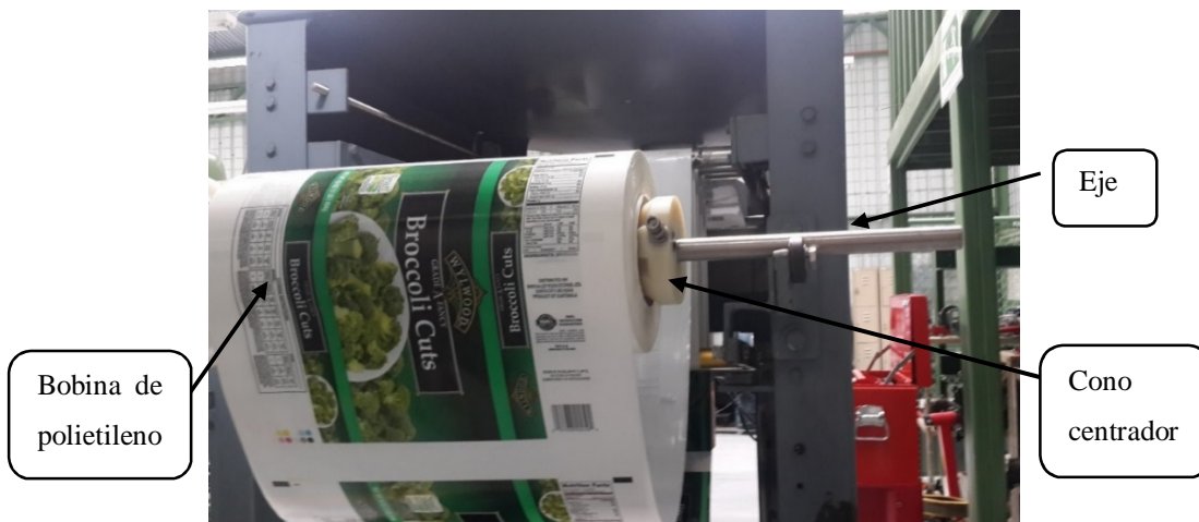
Figura 28. Montaje de bobina de polietileno en rodillos
