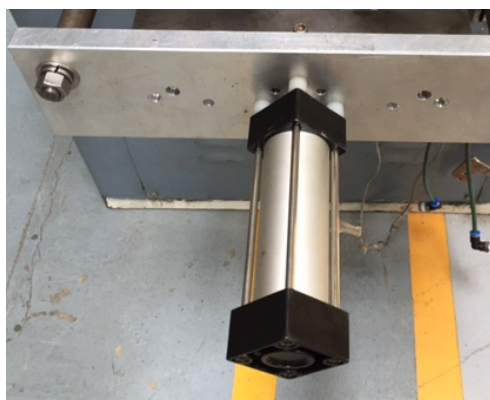
Figura 67. Montaje del pistón neumático SC40X75
