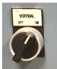
Figura 9. Selector de dos posiciones
