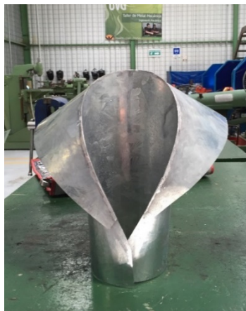
Figura 41. Formador circular final de lámina galvanizada
