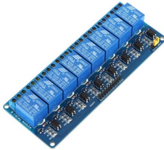
Figura 14: Módulo de relés de 8 canales
