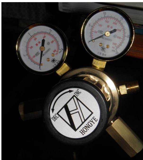
Figura No. 52: Regulador de presión que controla la presión de alimentación al tanque de almacenamiento
