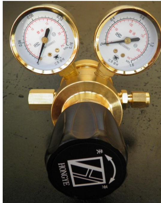
Figura No. 53: Regulador de presión que controla la presión de alimentación a la celda de combustión
