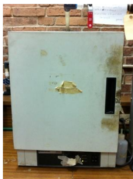
Ilustración 21 Horno utilizado para quitar la humedad de los dos sustratos: suero de leche de búfalo y estiércol de búfalo
