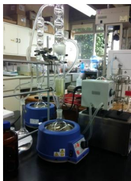
Ilustración 25 Soxhlet utilizado para la extracción de grasa de los dos sustratos utilizados: suero de leche de búfalo y estiércol de búfalo
