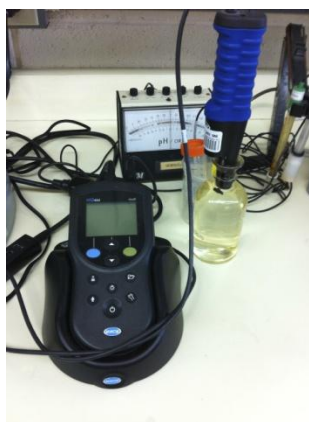
Ilustración 27 Multipropósito utilizado para medir el oxígeno disuelto de los dos sustratos utilizados: suero de leche de búfalo y estiércol de búfalo
