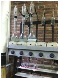
Ilustración 26 Digestor Kjeldahl para la digestión y destilación de los dos sustratos: suero de leche de búfalo y estiércol de búfalo
