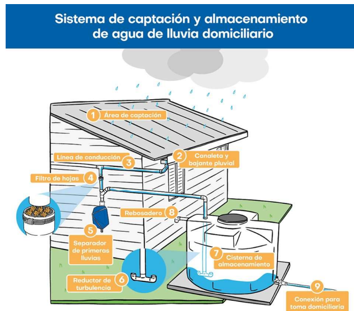
Figura 23. Componentes de un sistema de captación y almacenamiento de agua de lluvia domiciliario
