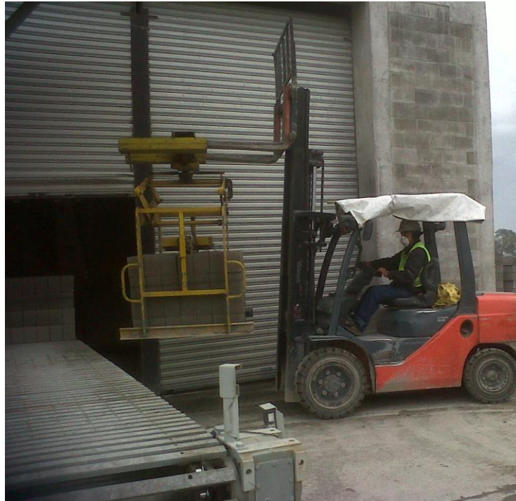
Imagen 21. Carril de salida y montacargas
