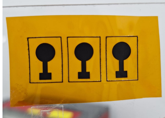
Figura 23. Electrodo LIG fabricado a partir de kapton® con sistema láser.
