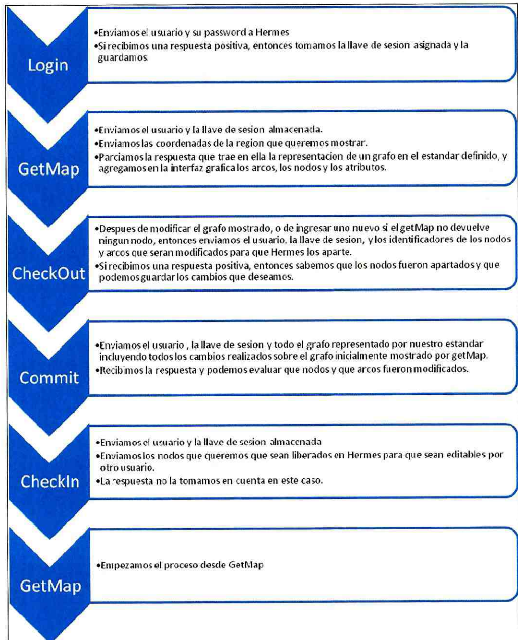
Ilustración 44. Flujo de datos al guardar un nuevo grafo
