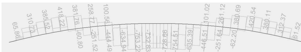
Dibujo cincuenta y uno: Diagrama de la fuerza torsionante que afecta al arco, la más importante en este diseño, valores en Kg.-m.
