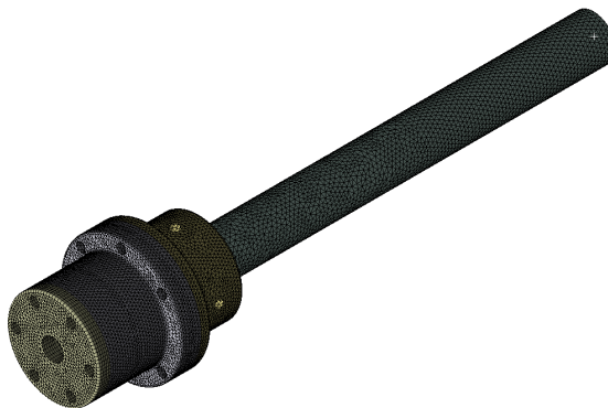
Figura 16. Mallado de la estructura en ANSYS 2019 R1.
