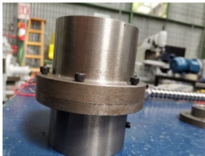
Figura 29. Montaje de acoples 1 y 2.
