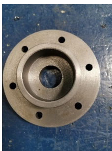
Figura 31. Vista de frente del acople 3.
