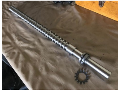
Figura 24. Acabado final del husillo.
