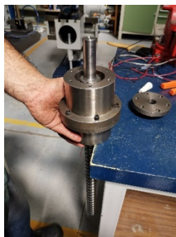
Figura 34. Montaje de husillo en el acople 2.
