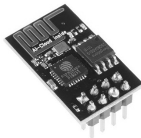
Figura 202. Módulo ESP-8266 de comunicación inalámbrica con protocolo Wi-Fi.
