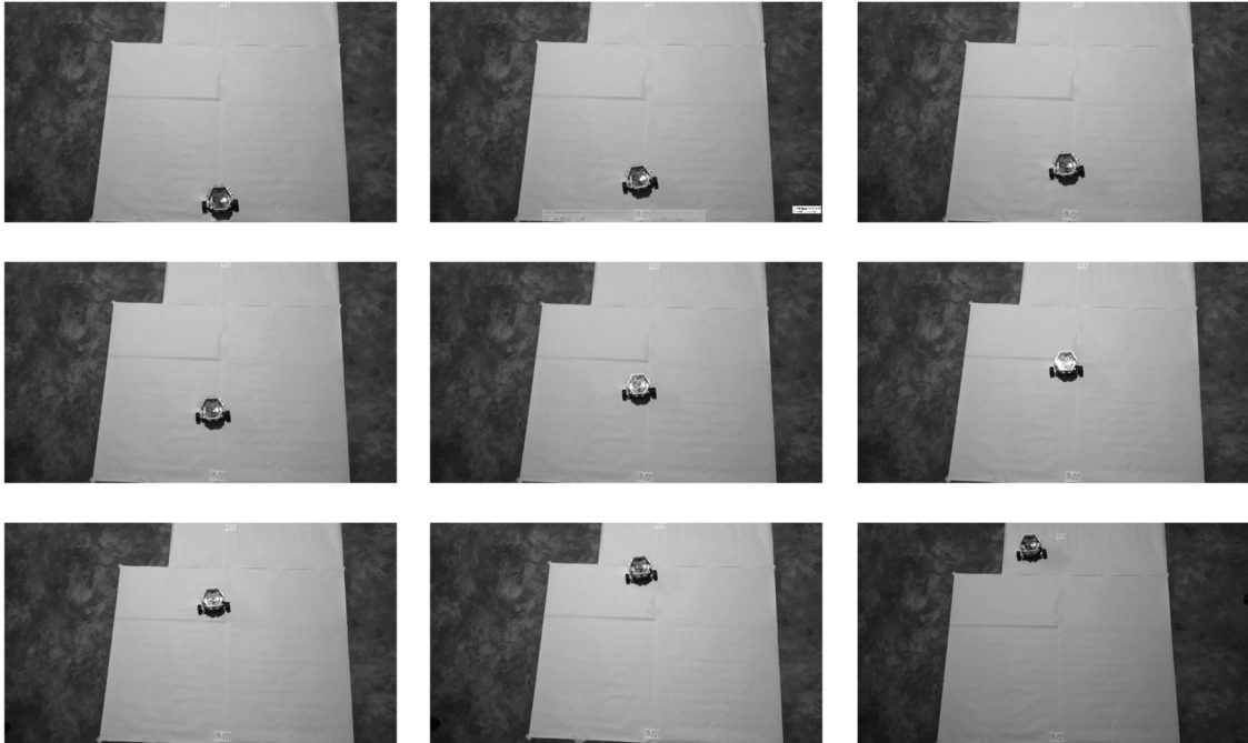
Figura 302. Secuencia de imágenes de la trayectoria seguida durante la prueba 4 de control proporcional
