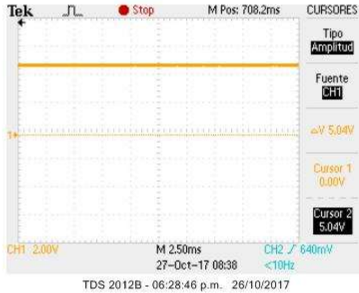
Figura 229. Línea de 5 voltios luego de ser filtrada.
