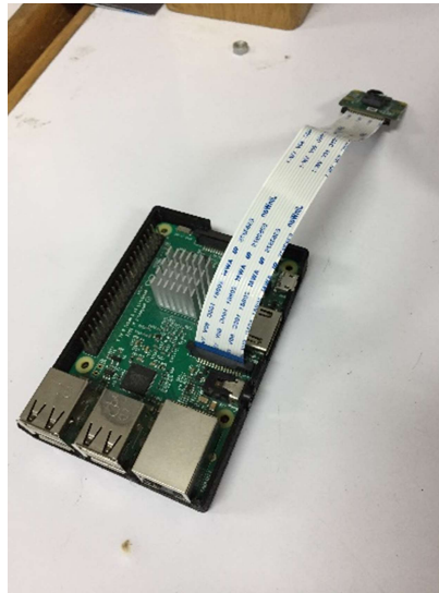
Figura 318: Conexión del módulo de cámara a Raspberry pi
