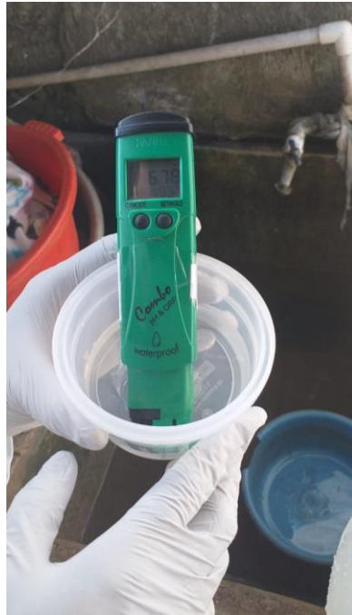
Ilustración 34. Medición con potenciómetro (Hanna Instruments Combo pH & ORP HI 98121) para los parámetros in situ (temperatura y pH) del agua en puntos de muestreo.
