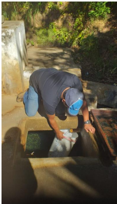
Ilustración 35. Medición de caudal en tanque de almacenamiento y distribución de agua de Aldea Santo Domingo El Rosario, El Tejar, Chimaltenango.
