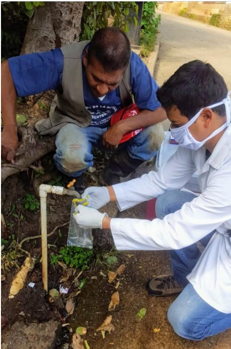
Ilustración 30. Proceso de toma de muestras de agua en grifo público llena cántaros para análisis microbiológico en acompañamiento del señor German Martínez, fontanero de los sistemas de agua de la comunidad.
