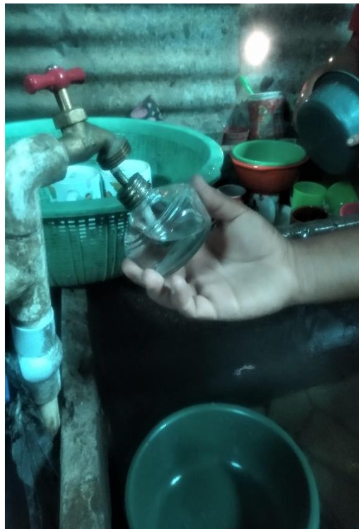
Ilustración 29. Procedimiento de desinfección de grifo domiciliario con mechero de metanol para toma de muestras de agua.
