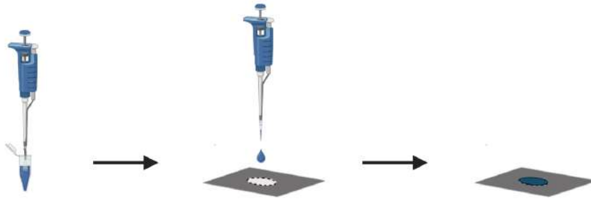
Figura 18. Colocación de colorante alimenticio en zona de detección para la evaluación de formación de áreas hidrofóbicas fuera del área de aplicación de la muestra en los prototipos fabricados
