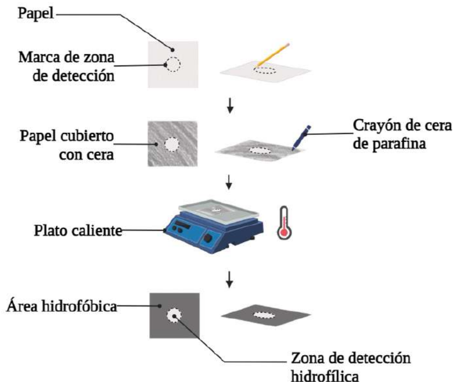
Figura 17. Procedimiento para la fabricación de dispositivos analíticos basados en papel utilizando la técnica de permeación con cera
