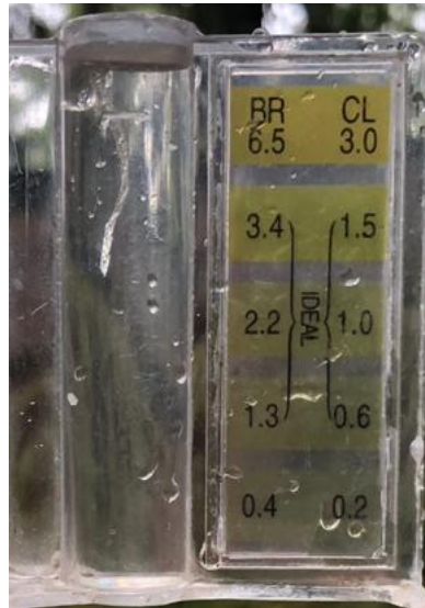
Figura 29: Prueba de cloro residual de pozo de agua de la comunidad Joya de las Flores, San Juan Sacatepéquez, Guatemala.
