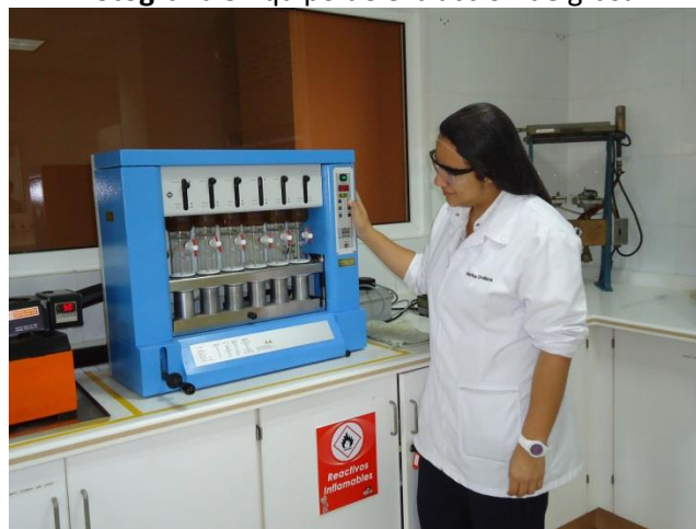
Fotografía 5 Equipo de extracción de grasa
