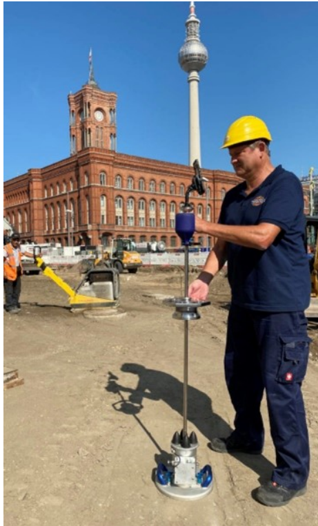
Figura 11. Deflectómetro de impacto liviano modelo 9000 LWD de Terratest
