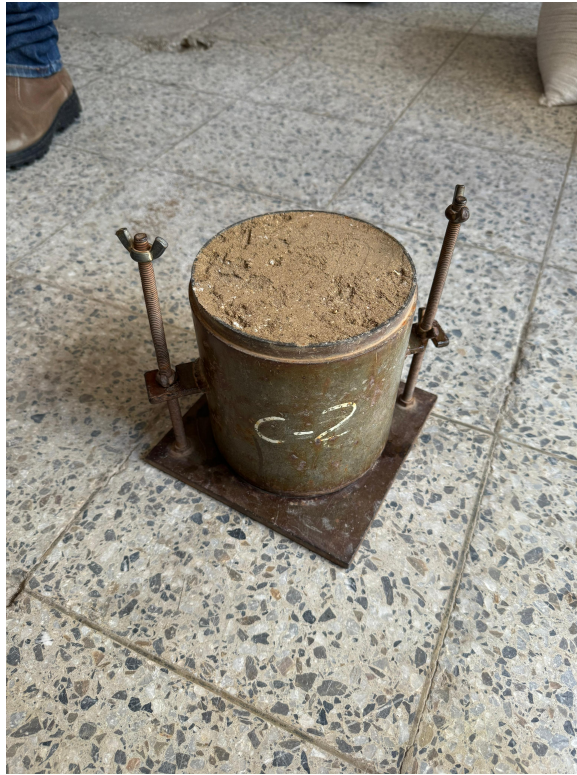
Figura 15. Ejemplo de muestra empleada para ensayo LWD
