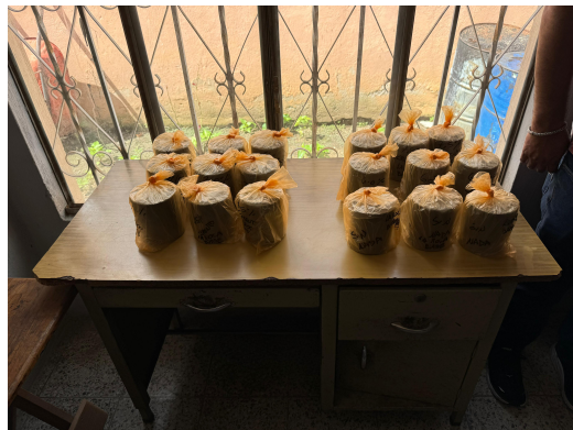
Figura 16. Grupo de muestras de La Roca destinadas a ensayo UCS
