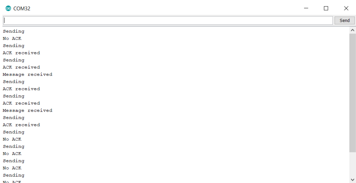
Figura 27: Primera prueba de comunicación con el dispositivo maestro desde el Feather32u4 RFM69HCW
