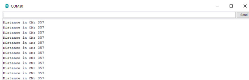
Figura 32: Resultados de la medición de distancia utilizando el sensor JSN-SR04T-2.0
