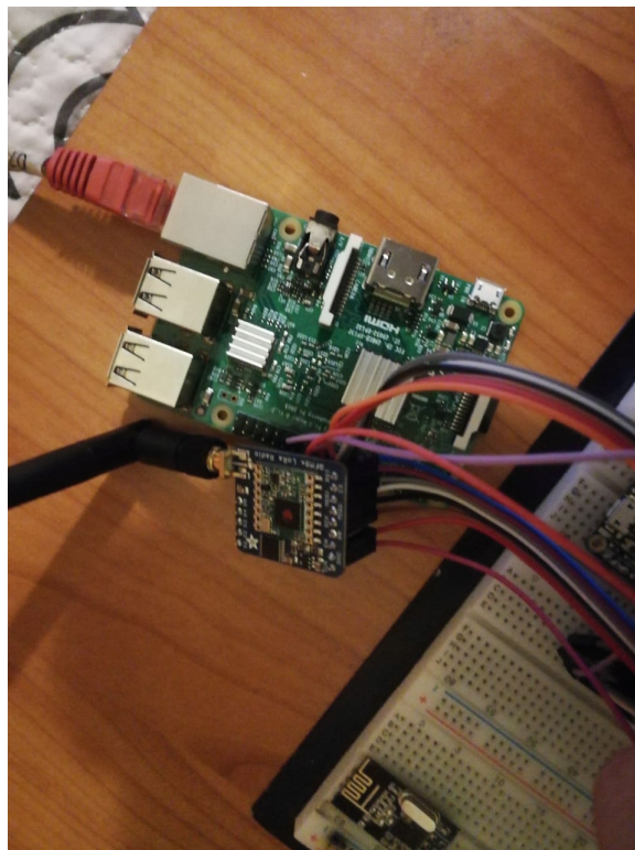
Figura 65: Conexión física de la Raspberry Pi 3 y del módulo RFM69HCW
