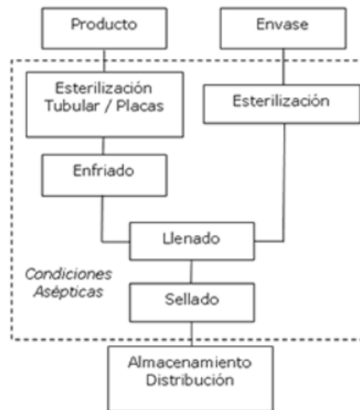
Gráfica No.3 Proceso de llenado aséptico del puré de banano. Fuente: Elaboración propia
