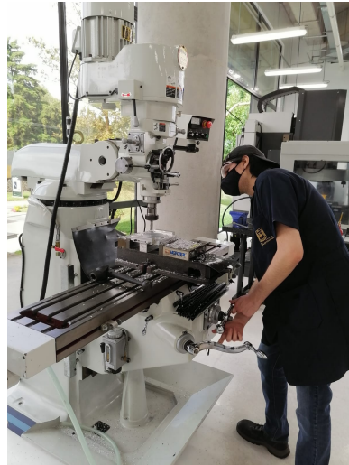
Figura 23: Fresado de piezas de aluminio
