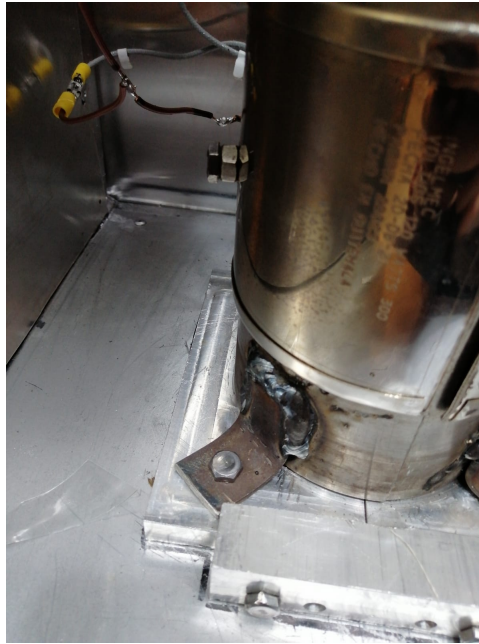
Figura 34: Sujetadores del molde a la base
