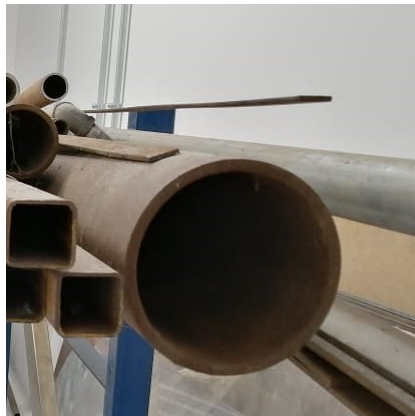
Figura 27: Tubo de acero A36
