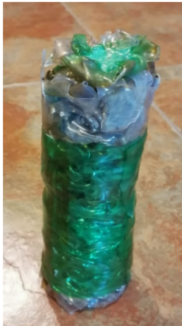
Figura 47: Ecoladrillo formado a 250 °C
