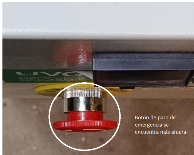
Figura 10. Paro de emergencia desactivado
