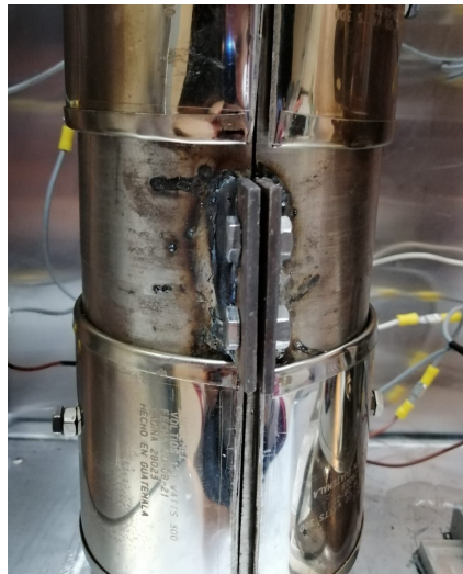
Figura 35: Pestañas de cierre del molde
