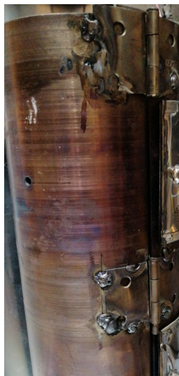
Figura 33: Bisagras del molde
