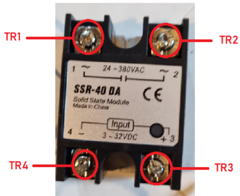
Figura 9. Terminales relé de estado sólido
