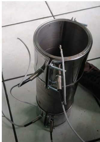
Figura 31: Ensayo de resistencias en el molde
