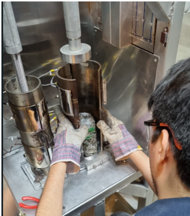
Figura 14. Separación de molde para retiro de plástico
