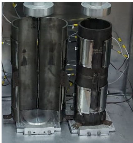
Figura 36: Sistema de molde y calentamiento
