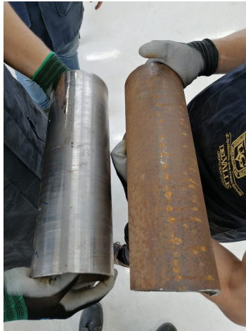
Figura 30: Comparación entre molde oxidado y molde torneado
