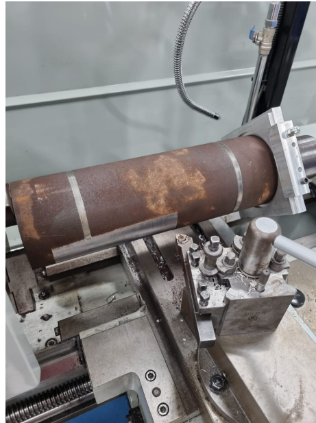
Figura 29: Ajuste entre la base y el molde posterior al torneado
