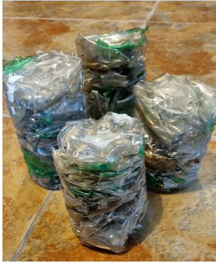
Figura 46: Ecoladrillo formado a 180 °C
