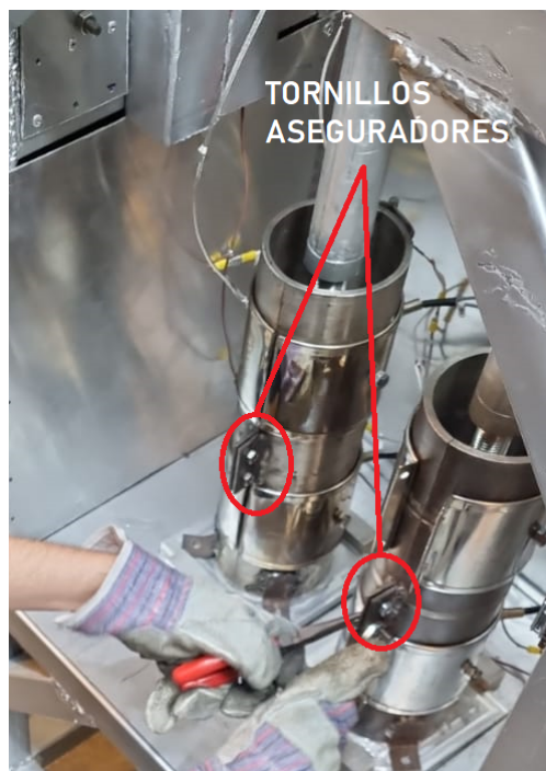
Figura 5. Proceso de sujeción de cavidades por medio de tornillos
