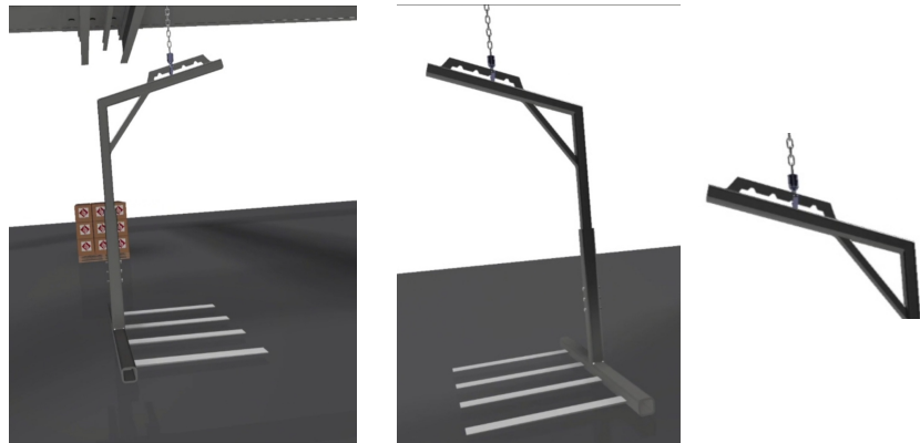
Figura 59: Colocación de cadena
