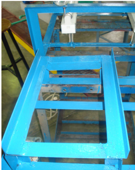
Fotografía 3. Estructura que sostiene a la bomba peristáltica
