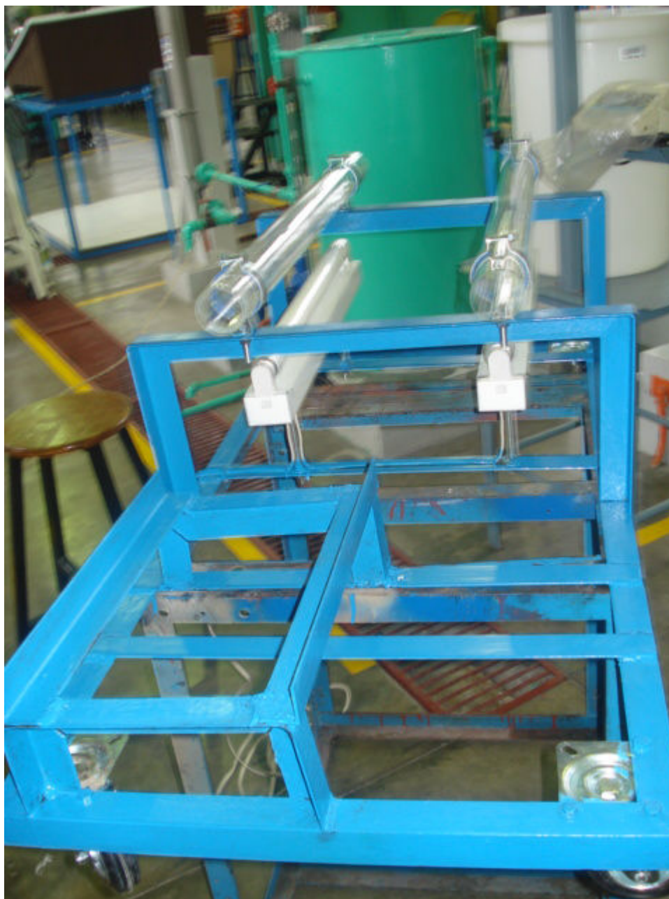
Fotografía 1. Estructura que sostiene a Fotobioreactor Tubular continuo.
