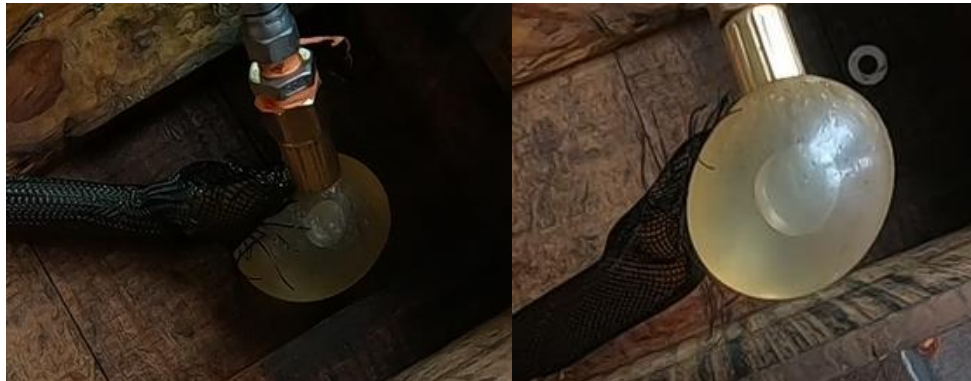
Figura 18 PAM-C estado luego de prueba destructiva
