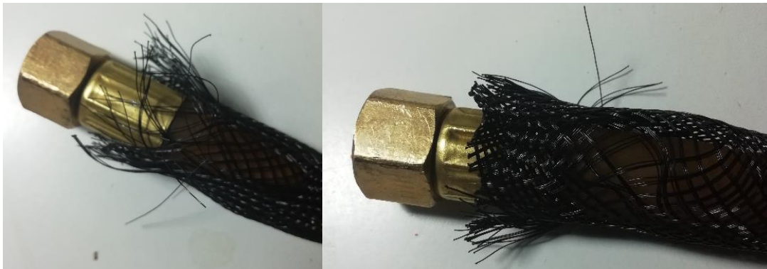
Figura 19 Estado del entretejido de PAM-C sin presión
