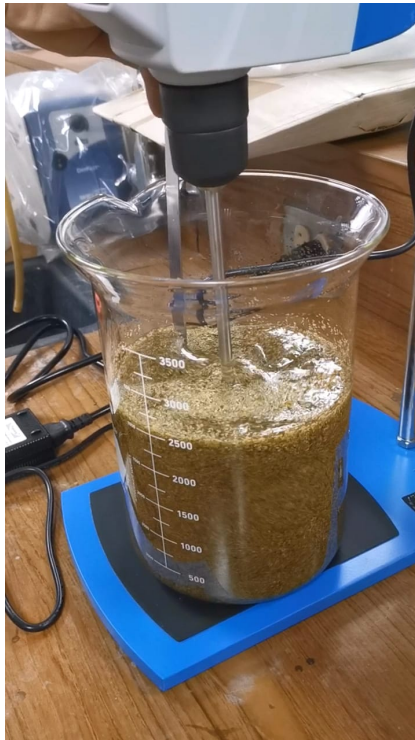
Figura 49: Mezcla de agua y manzanilla con agitador centrado y deflector
