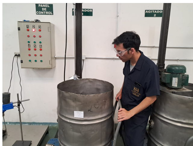
Figura 76: Preparación del agitador para mezclar en tanque de 200 kg
