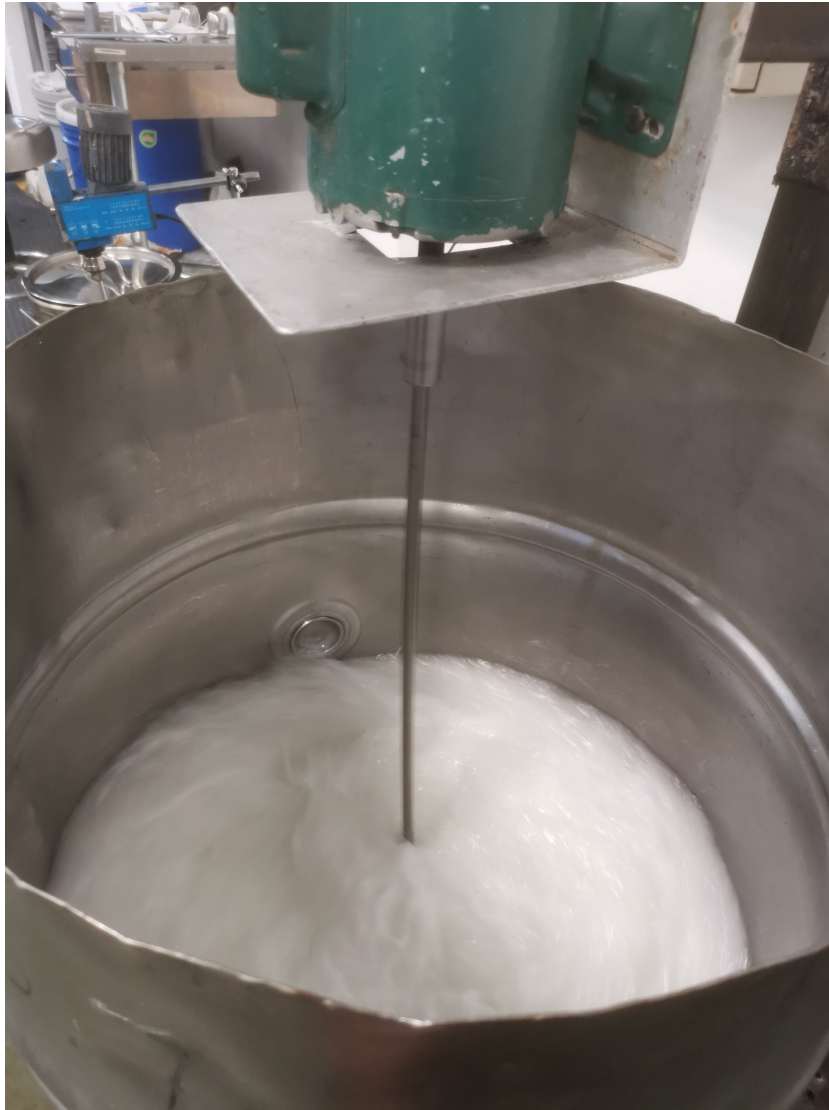
Figura 80: Agitación del tanque de 200 kg con el eje desfasado
