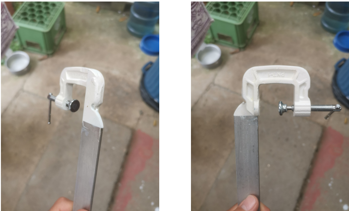
Figura 75: Deflector con sargento soldado y acabado de pintura
