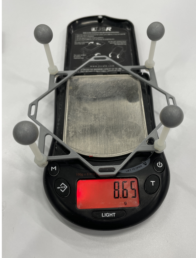
Figura 34: Peso de Frame para Crazyflie 2.0
